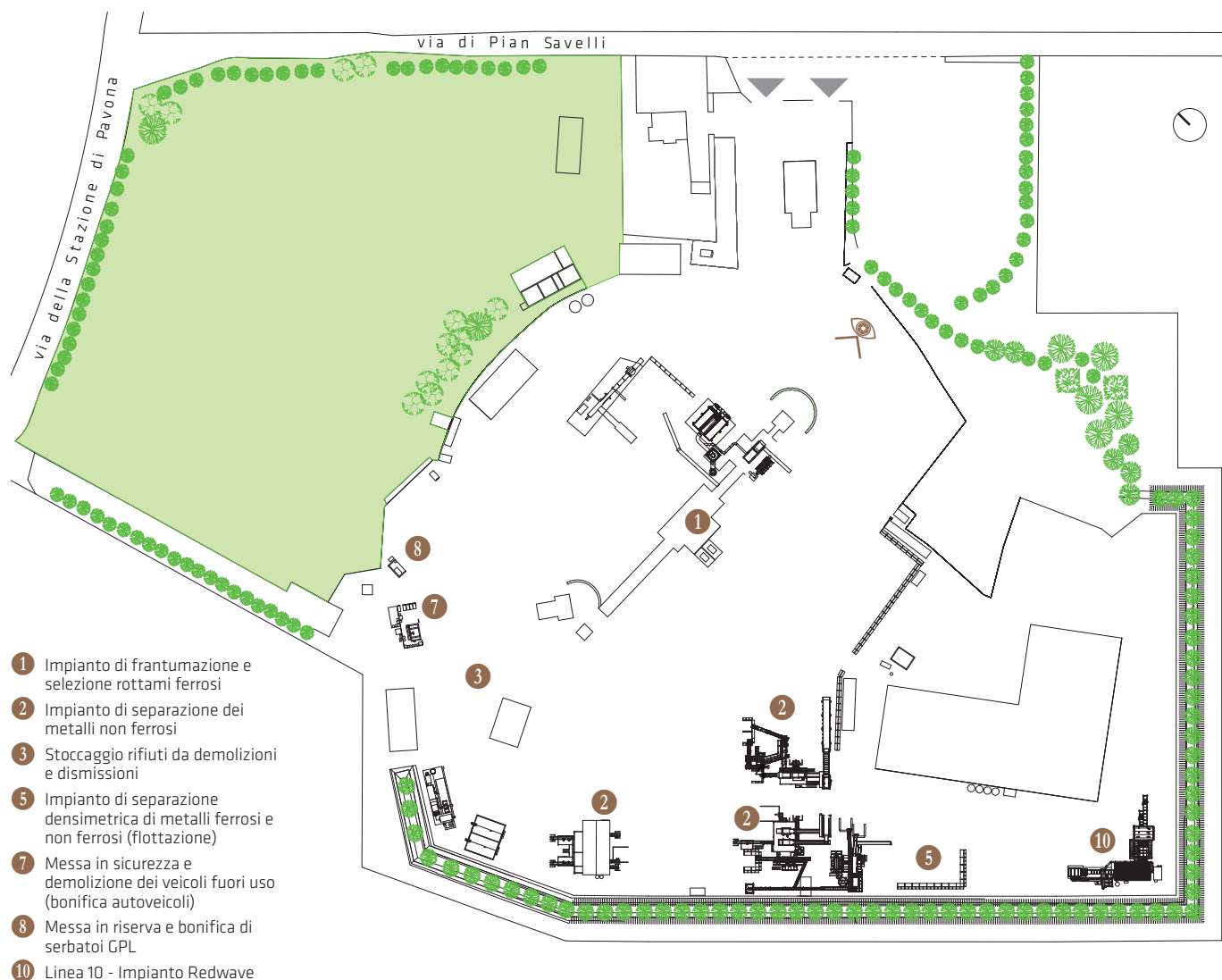
Fig. 3 Planimetria dell'impianto con l'indicazione dei numeri delle Linee e indicazione del punto di ripresa fotografica Scala 1:2000
